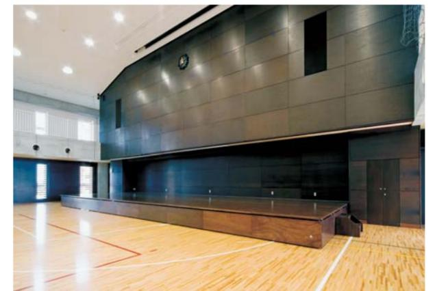
体育館 / 電動折りたたみステージ「アイスステージ」:WF-144-446C (W14400・D4400・H600mm)
