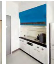
ドラフトチャンパー 有害気体等の取り扱い に必要な局所排気装置。
