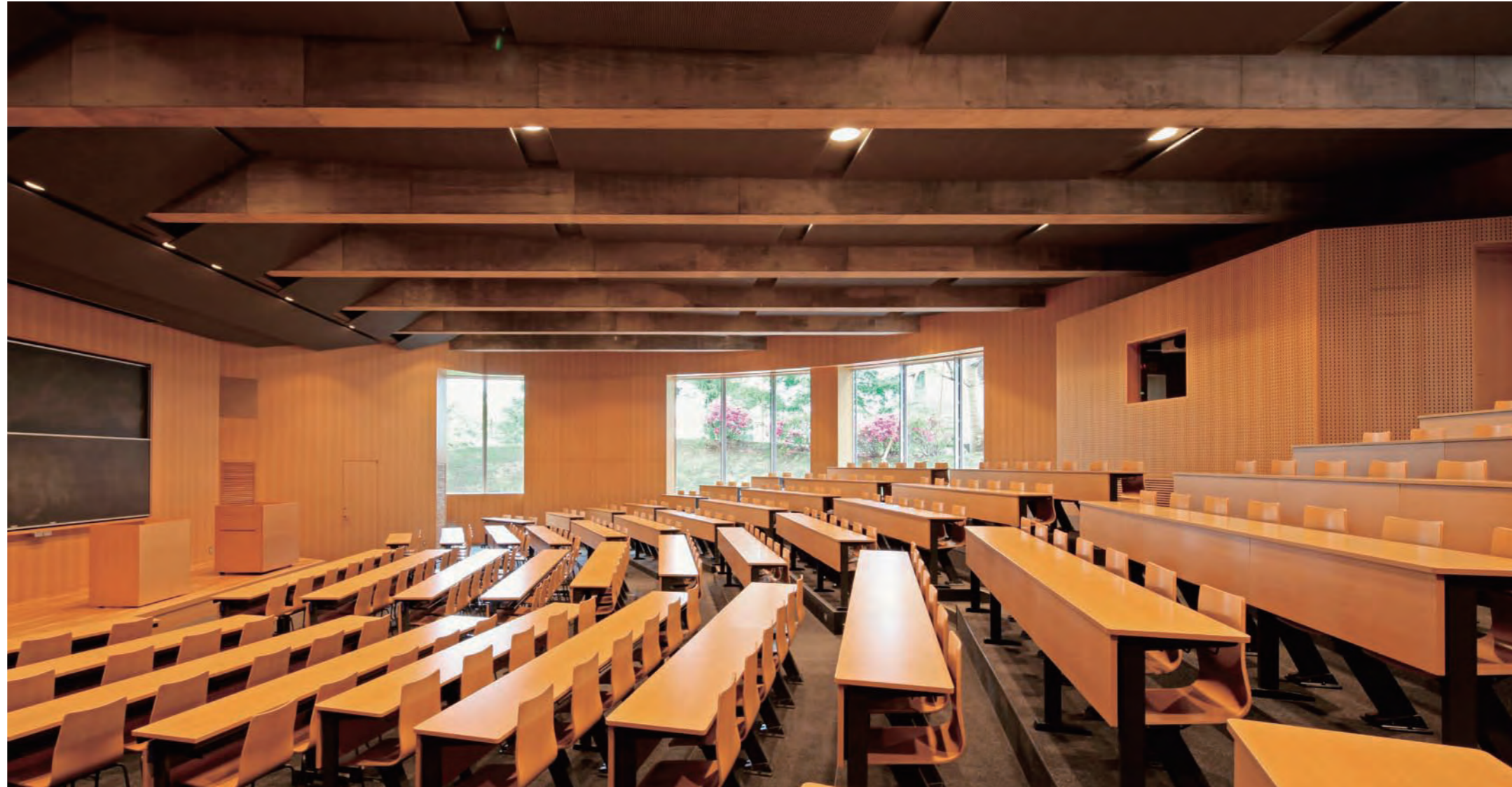
▲大教室／講義デスク・イス:SCF-5105 230席、移動席テーブル:CTN2特注品、イス:SCM-5105-C 71席 設計時に求められた大きな機能のひとつ“大学の顔”として、新設された300人規模の大教室。傾斜地を利用した階段教室で、他の部屋とは仕上げを変え、暖かみのある木調としている。収容人数が多く、試験でも使用されることをふまえ、床固定のイスは後方を通り抜けできるタイプが採用された。建築意匠とマッチしたシンプルでデザインで、頻繁な使用に耐える傷が付きにくいものとなっている。前方の平場部分は、キャスター付テーブルとスタッキングチェアを設置し、移動や収納も可能。音響は、天井板を傾斜させて反射音を調整したり、天井の隙間の躯体に吸音パネルを仕込むなど、どこからでも講義が良く聞こえるように、様々な配慮がされている。
