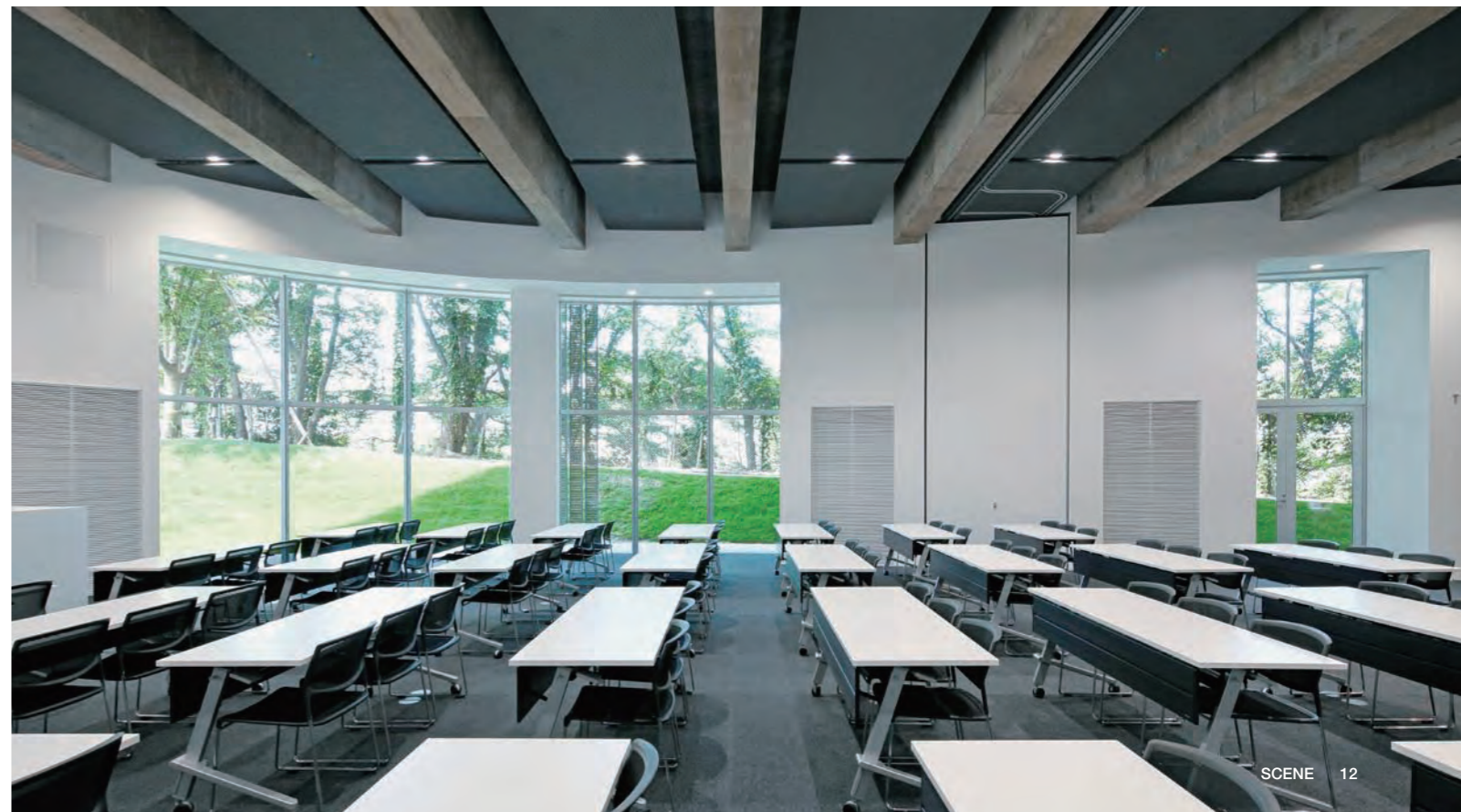
▲大教室／講義デスク・イス:SCF-5105 230席、移動席テーブル:CTN2特注品、イス:SCM-5105-C 71席 設計時に求められた大きな機能のひとつ“大学の顔”として、新設された300人規模の大教室。傾斜地を利用した階段教室で、他の部屋とは仕上げを変え、暖かみのある木調としている。収容人数が多く、試験でも使用されることをふまえ、床固定のイスは後方を通り抜けできるタイプが採用された。建築意匠とマッチしたシンプルでデザインで、頻繁な使用に耐える傷が付きにくいものとなっている。前方の平場部分は、キャスター付テーブルとスタッキングチェアを設置し、移動や収納も可能。音響は、天井板を傾斜させて反射音を調整したり、天井の隙間の躯体に吸音パネルを仕込むなど、どこからでも講義が良く聞こえるように、様々な配慮がされている。
