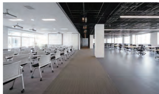
講評室と製図室はオープンに連続。構造や設備を見せるため天井をメッシュに。
