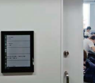
デジタルサイネージ(上)と電子ペーパー(下)／デジタルサイネージは情報を目的に合わせて表示。教室入口に設置された電子ペーパーは授業情報を表示。省エネと情報発信の向上のために、電子化しペーパーレスを目指す。
